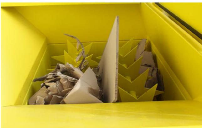
Le broyeur à carton PRESTO est un dispositif d'introduction pour le broyage de cartons encombrants et de palettes en carton à usage unique.
